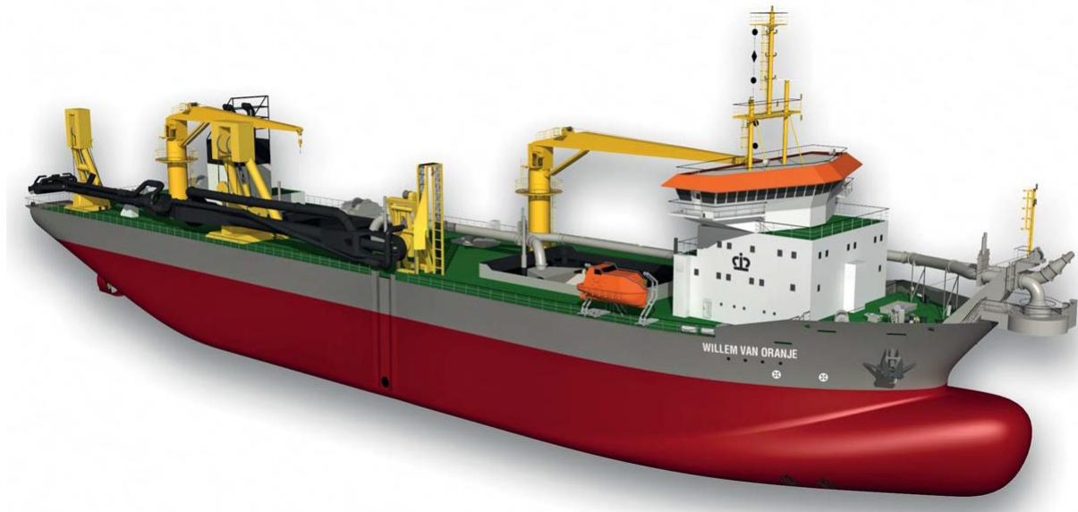
Figura 2.10.- Draga de Succión en Marcha
