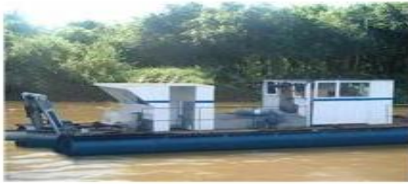
Figura 2.9.- Dragas de Succión
