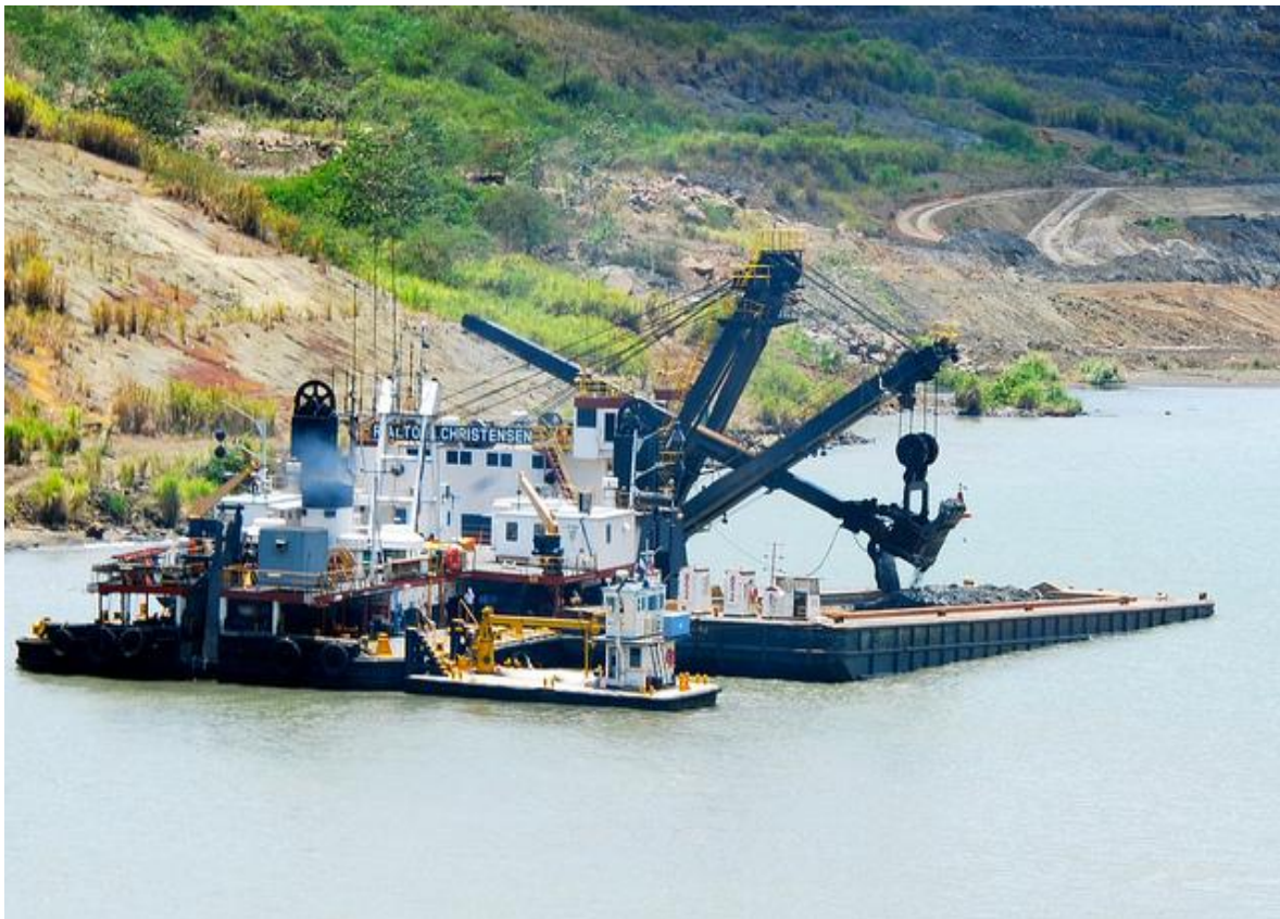
Figura 2.7.- Draga tipo Pala
